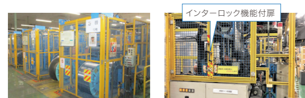
製造工程における巻替機等の可動部への巻き込まれリスク低減に向けた取り組み 溶接事業部門 茨木工場での事例 (可動部へのインターロック機能を有した安全柵等の設置を推進)
