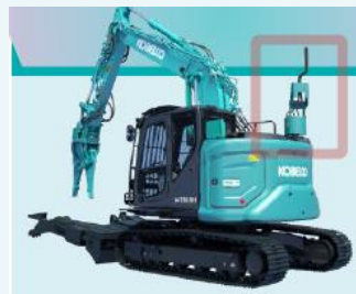
電動仕様機（自動車解体機） 2003年 排出ガスゼロ、給油不要 で連続稼働が可能に
