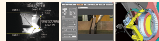
(左) AI溶融池センサ (中央) 生産支援DX: ARCMAN™ View (右) ロボット指示レス: ARCMAN™ Offline Teaching System
