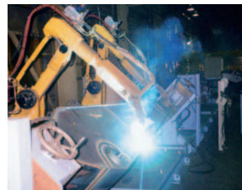
建機部品溶接ロボットシステム
