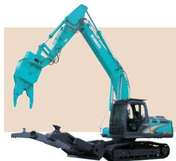
電動マルチ解体機[SK210D]
