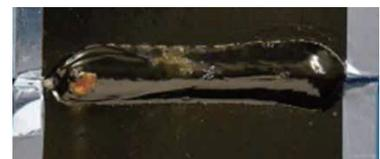
※電着塗装膜厚: 20μm, JASO M609-91「自動車用材料腐食試験法」に準拠 45サイクル
