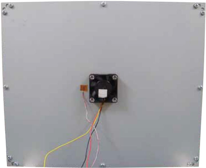
③ EG製蓋にファンを取付け
