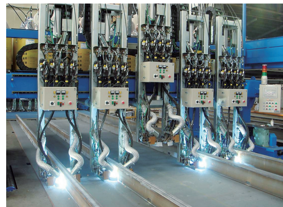
ラインウェルダ 水平すみ肉溶接施工法
