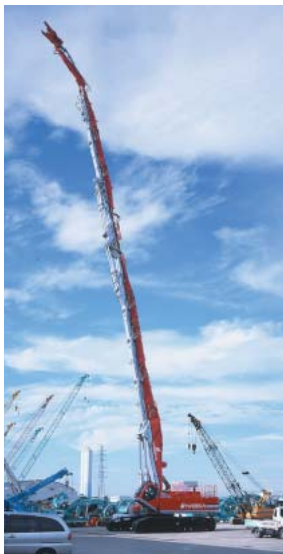
世界最大のビル解体専用機「SK1600D」
