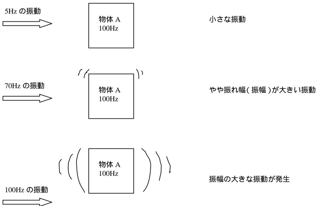
上図で示すように、例えば固有振動数が 100[Hz]の物体 A に同じ力で振動数の異なる振動を与えると、5[Hz]の振動数の場合物体はほとんどしなくても、与える振動数が物体の固有振動数に近くなるにつれ、物体 A は与える力が同じでも大きな振動となる（共振現象）。ユニフォミティマシンにおいて、共振現象が起こると正確な測定が行えなくなる。この共振現象の要因としてタイヤの回転数があげられる。
