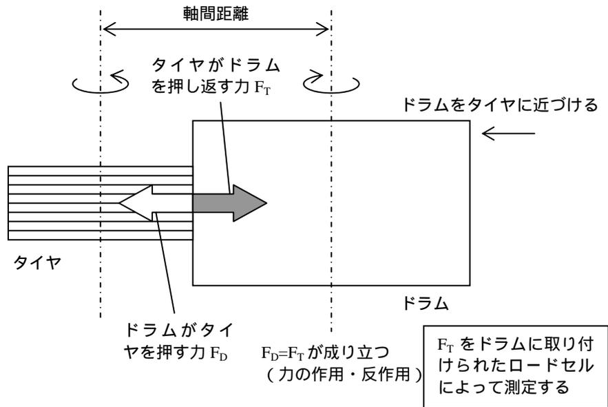
実際には右図のように3方向の力が働いており、タイヤユニフォミティマシンではそれぞれの変動量 RFV,LFV,TFV を測定し、タイヤ形状の均一性を判断する。
