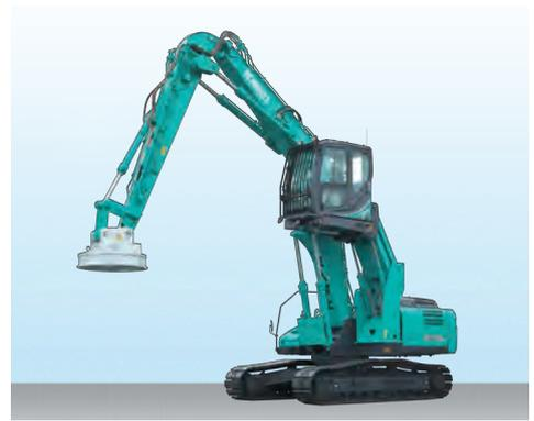
搭载“eMAG”系统的抓钢机
