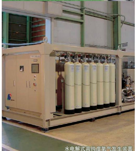
水电解式高纯度氢气发生装置
