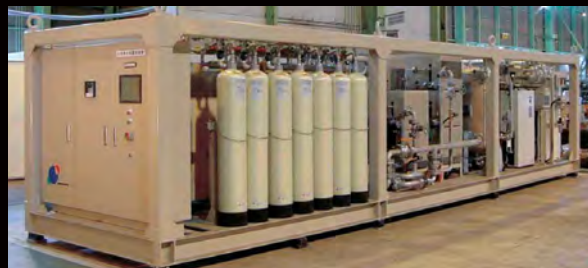
水电解式高纯度氧气发生装置
