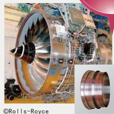
©Rolls-Royce 钛制风扇机匣和喷气发动机
