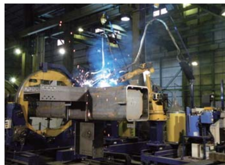
柱式装配焊接机器人系统
