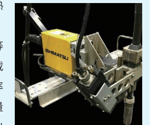
搭载熔池传感器的小型移动焊接机器人“石松”
