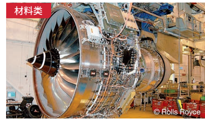
应用于飞机发动机零部件的钛材
