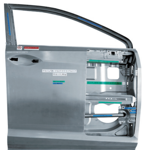
神钢集团自主研发的复合材料门结构（试制品）
