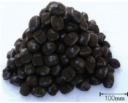
Fig. 7 UBC briquette
