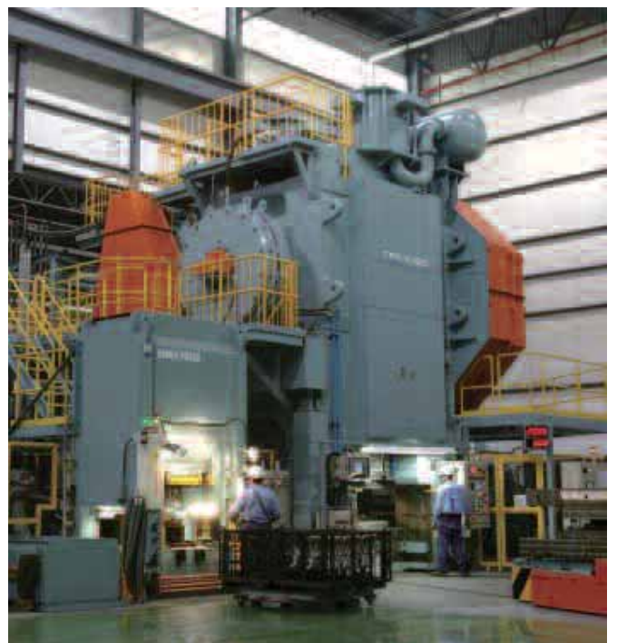
KAAPの6,300トンプレス設備
