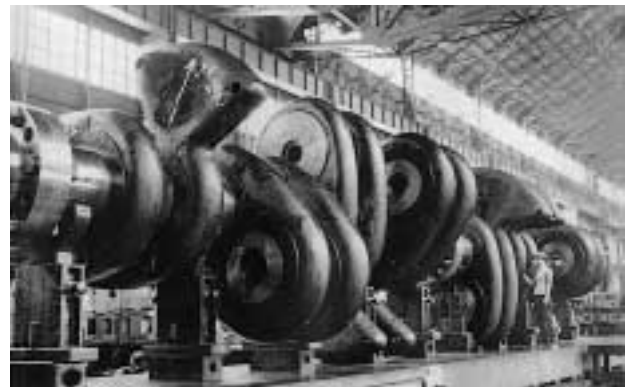
写真 1 全組立型クランク軸 (B&W タイプ 884VT2BF-180) Photo 1 Full built-up crankshaft (B&W type 884VT2BF-180)
