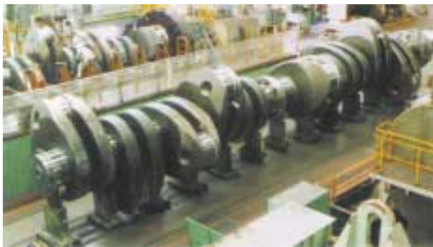
写真2 半組立型クランク軸 (MAN B&W タイプ 10L80MC) Photo 2 Semi built-up crankshaft (MAN B&W type 10L80MC)
