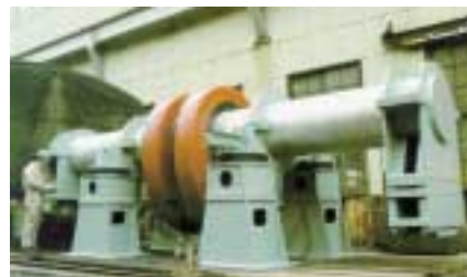
写真4 実体疲労試験装置 Photo 4 Fatigue testing machine for actual-sized crankthrow
