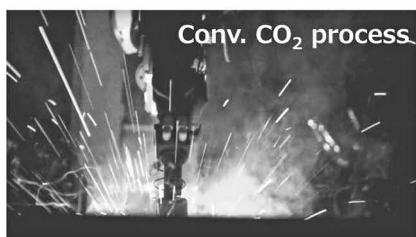
Wire feed rate : 16 m/min 350 A-37 V-500 mm/min
