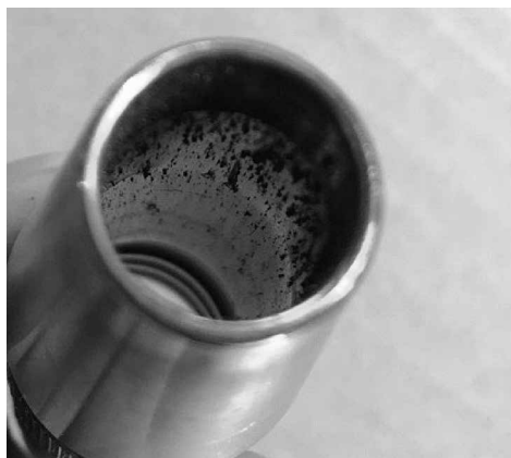
図3 40分間連続溶接後のノズル外観
