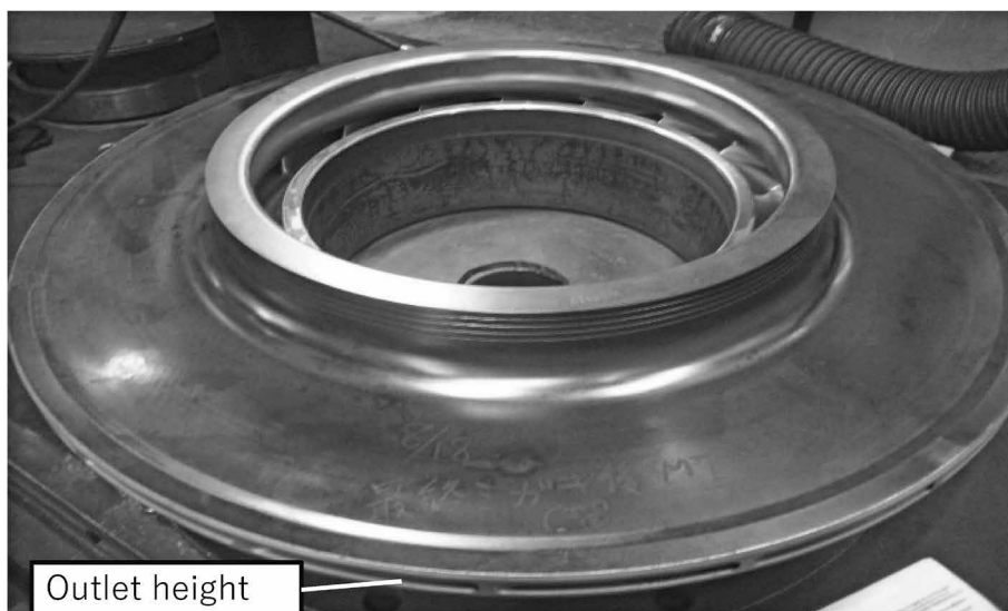
図9 スロット溶接した2Dインペラの外観 Fig.9 Appearance of 2D impeller with slot welding
