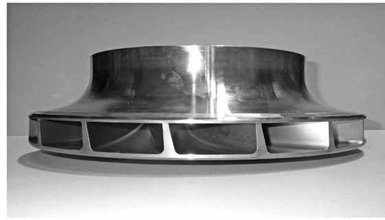
図6 液相拡散接合による3Dインペラの外観 Fig.6 Appearance of 3D impeller with liquid diffusion bonding
