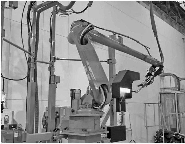
図15 ガスバーナー Torch 着火動作 Fig.15 Auto ignition action of pre-heating burner torch
