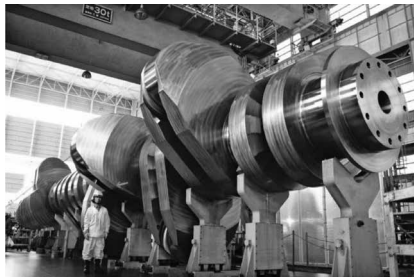
(a) 大型船舶用組立型クランク軸 9) (a) Build-up type crankshaft for large ships 9)
