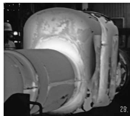
図5 実機試作で得られた鍛造形状 Fig. 5 Actual forging shape
