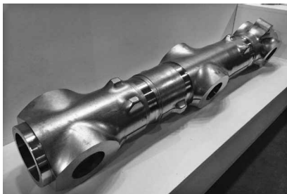
(c) チタン合金製航空機用着陸装置部材 11) (c) Titanium alloy aircraft landing gear parts 11)
