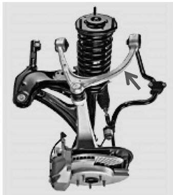
(b) 自動車サスペンション用アルミ鍛造部材 10) (b) Aluminum forged parts for automobile suspension 10)
