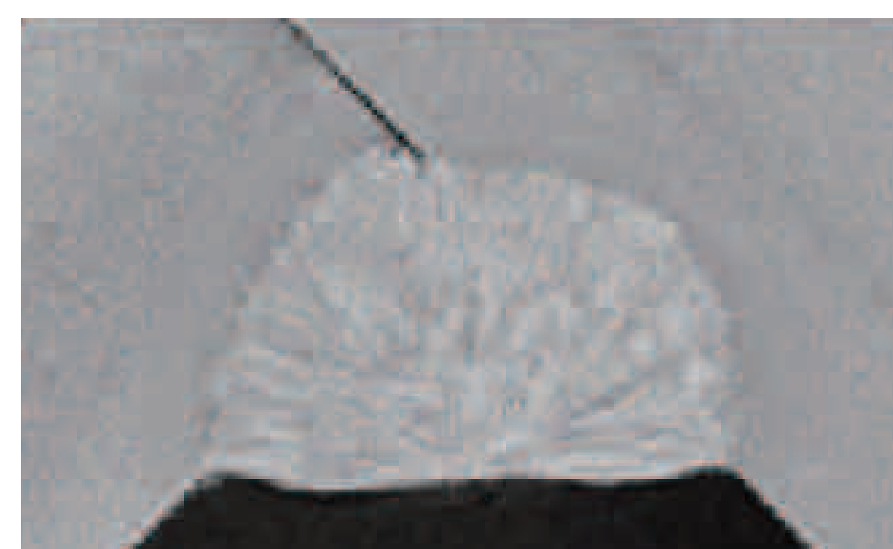
脚長=9.5 / 9.3(mm) 溶接条件：280A-200mm/min
