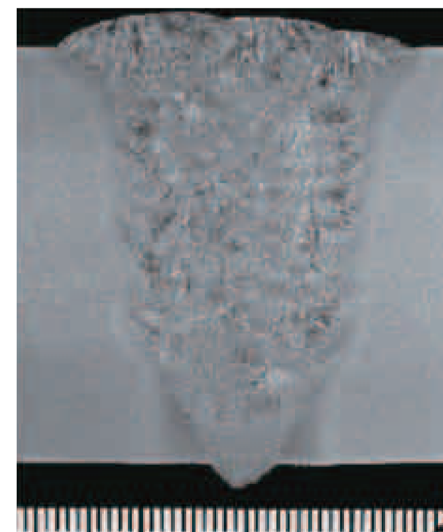
PF-90B9/US-90B9溶着金属の ミクロ組織の一例 / Microstructure of All Weld Metal(Example)
