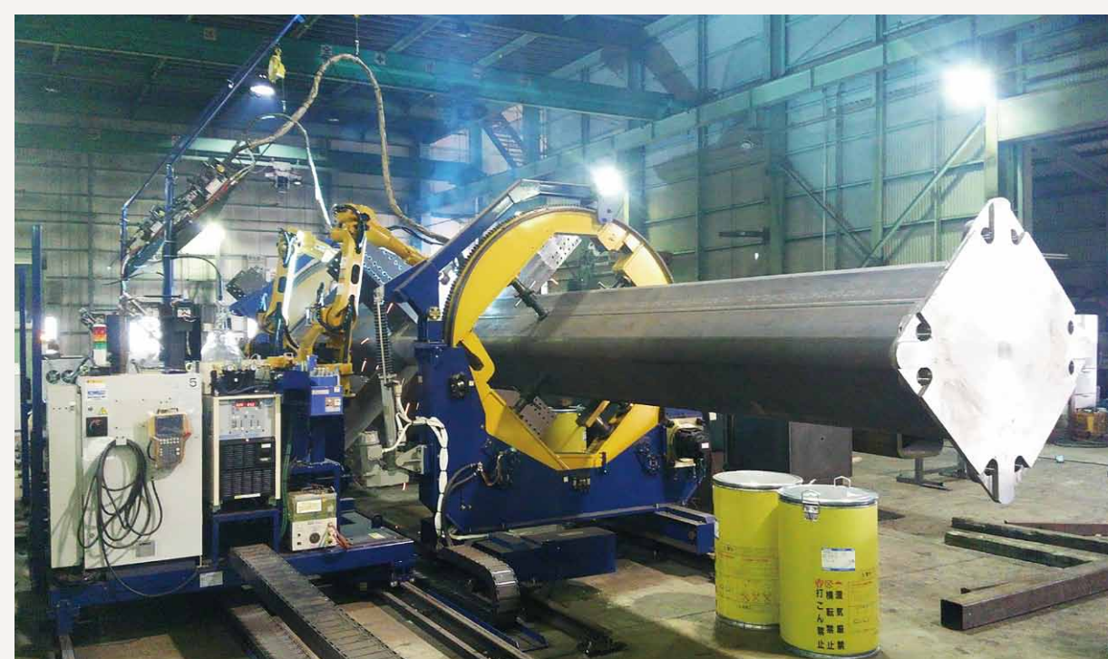
鉄骨柱大組立 溶接ロボットシステム
