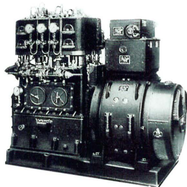
高圧圧縮機（1928年頃）
