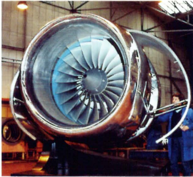
チタン合金製ジェットエンジンファンケース
