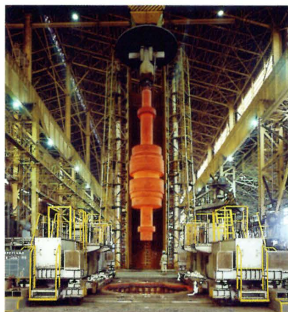
8,000トプレスによるロータシャフト製作
