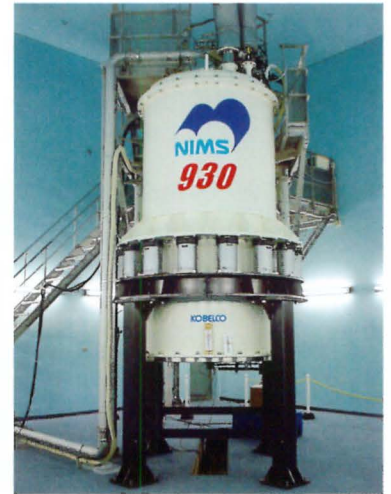
NIMS930 世界で初めて900MHz超級の大型超電導マグネットの開発に成功（2001年）
