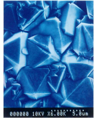
熱フィラメント化学気相合成法（CVD）で作られたダイヤモンド薄膜（1982年）
