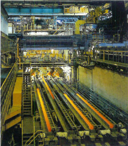
神戸製鉄所 第4号連続鋳造設備 第4号連続鋳の稼働後、第3号連続鋳をリフレッシュした。現在、第5号連続鋳を建設中である
