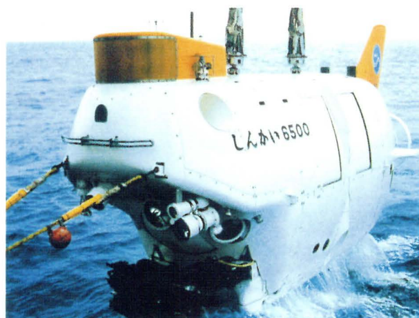
しんかい6500 深海潜水調査船用材料として採用されてきたチタン合金。有人制御室用の大型耐圧球殻材を供給した
