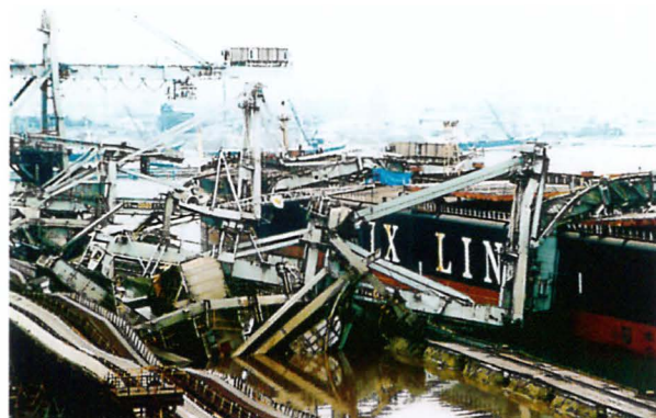
阪神・淡路大震災で倒壊した加古川製鉄所のアンローダ。神戸製鉄所も壊滅的な打撃を受けた
