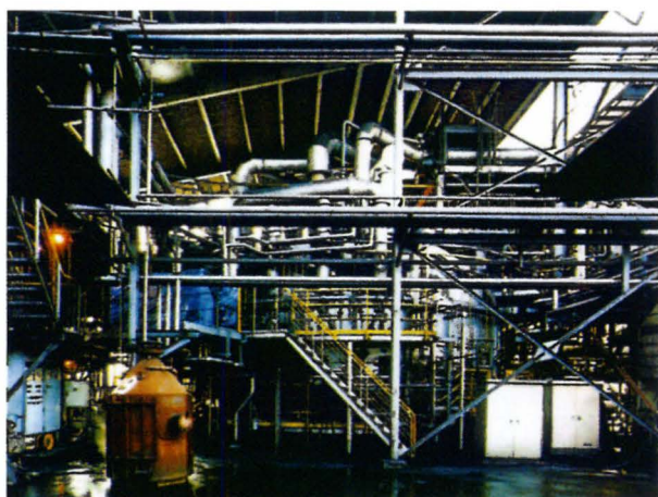
FASTMET 製鉄所のダスト類のリサイクルに威力を発揮している
