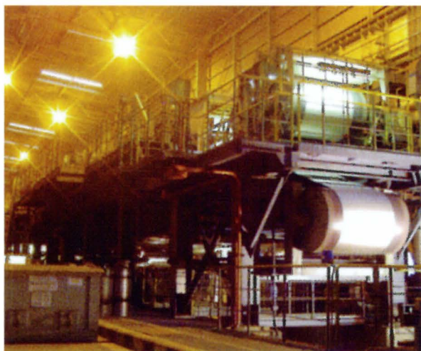
加古川製鉄所 チタン専用連続焼鈍酸洗ライン（APL） 製品形状を整え、優れた表面品質をつくり出す。チタン専用としては世界唯一
