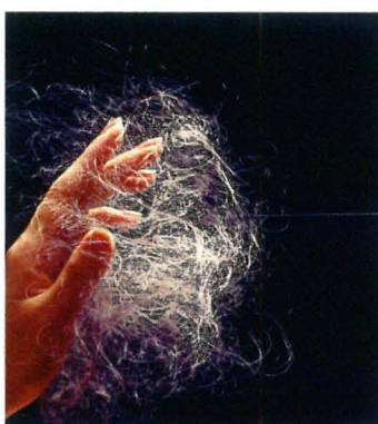
サイファー 髪の毛のように細いが、引張強度はピアノ線の30~50%高い。スポーツ、レジャー製品に使用された
