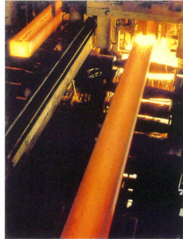
神戸製鉄所 第3号連続鋳造設備 無欠陥鋳片の製造技術を目指しリフレッシュ工事を実施した
