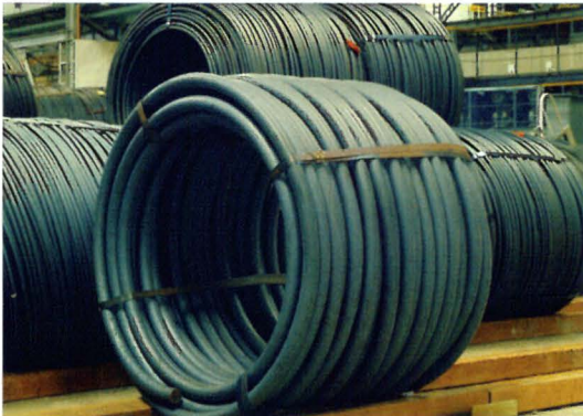
60mm太径線材 新棒鋼工場内に建設された巻取設備は最大径60mm（世界最大）の線材生産を可能にした。コイル化が進む特殊鋼棒鋼の傾向を先取りしたものである
