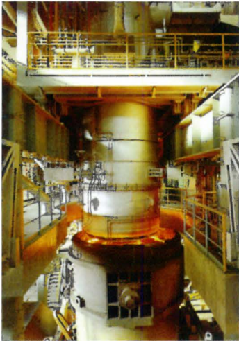
高級鋼の量産化のために導入したRH式真空脱ガス装置
