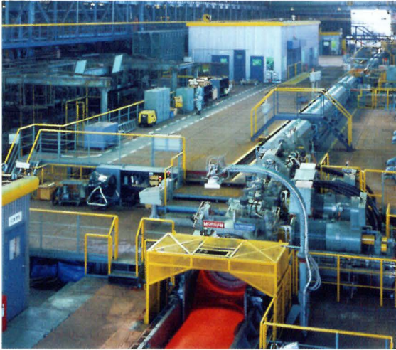
神戸製鉄所 第7線材工場のリフレッシュ 1969年の稼働以来、弁ばね用線材を製造してきた第7線材工場が、加熱炉と圧延ラインを中心にリフレッシュした
