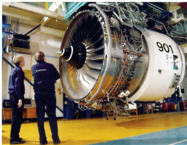
超大型旅客機エアバスA380に搭載するエンジンTrent900（ロールスロイス社）にも当社チタン材料が使われている
