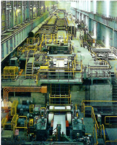
加古川製鉄所 No.2電気亜鉛めっき設備 薄板の高級化、多様化などのニーズに対応した
