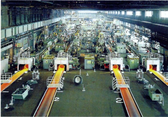
リフレッシュした加古川製鉄所の第8線材工場 品質、生産性の向上だけでなく、鋼片寸法を神戸製鉄所と同一とし、両製鉄所間での鋼片の振り分け圧延が可能となった
