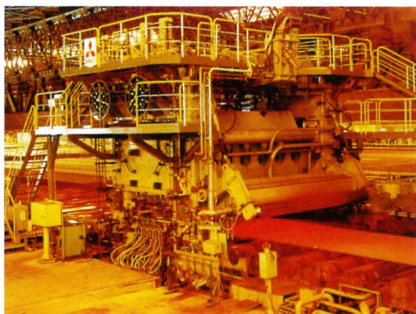
加古川製鉄所に導入した国内最大級の熱処理レベラ
