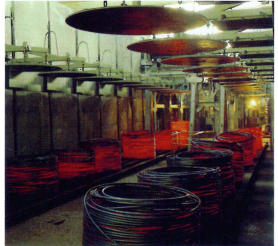
神戸製鉄所 新棒鋼工場の線材巻取りおよび搬送設備
