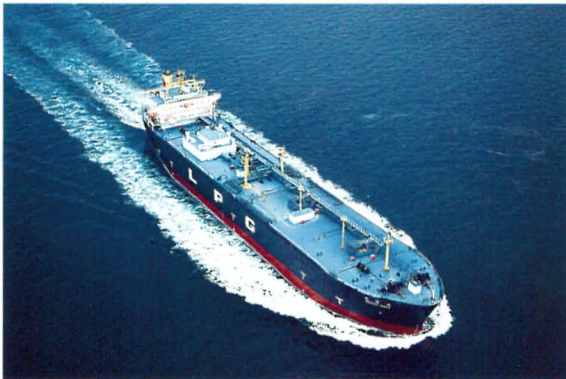
ヒズミレスを使用したLPG運搬船 ガス切断や溶接など加工時の変形バランスを従来の半分以下に低減したTMCP鋼板
