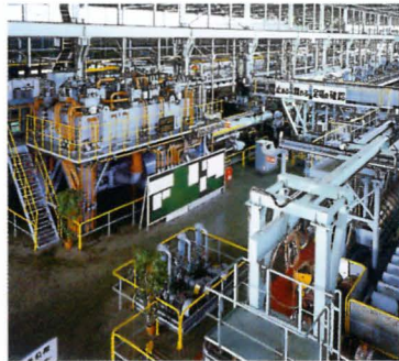
長府製造所 3,900トンの押出プレス
