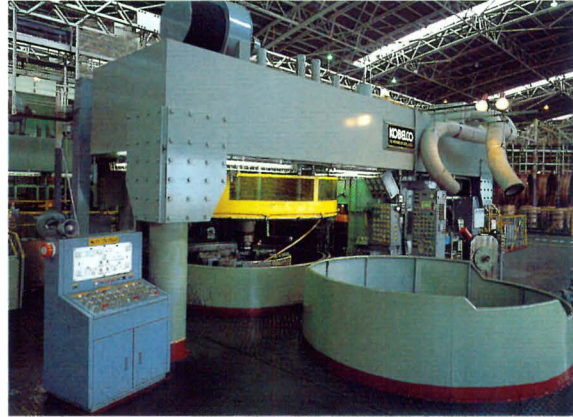
秦野工場 プルブロック設備
