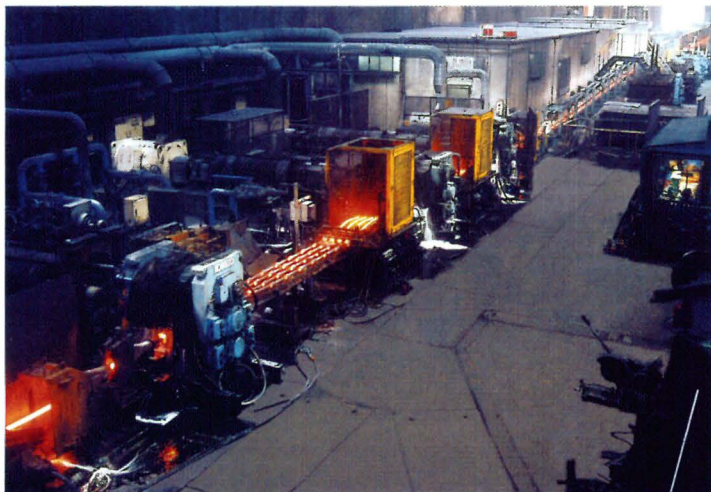
4条スリット圧延設備
