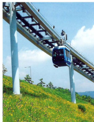
ロープウェイとモノレール技術を組み合わせた簡易型交通システム「スカイレール」
