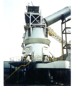
小野田セメント株式会社と共同開発したセメント仕上げ用粉砕機「OKミル」
