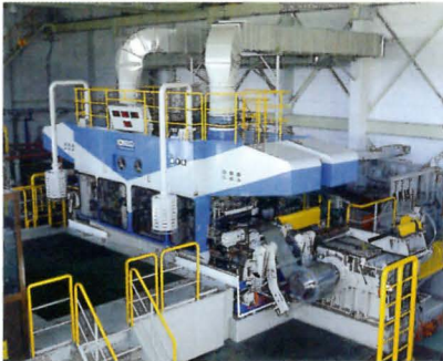
銅やステンレスなど中硬質の金属材料の圧延に適した12段圧延機「KTミル」
