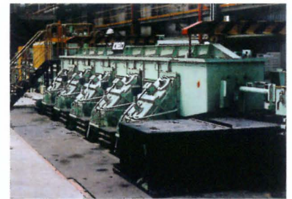
操業が容易な高速線材圧延機「S-HUM」
