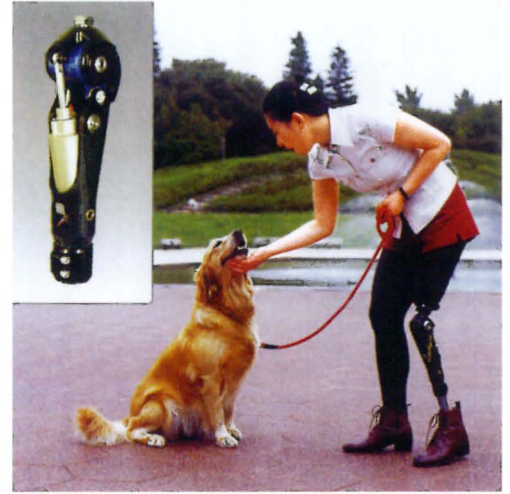
制御システム技術を応用した「インテリジェント義足」
