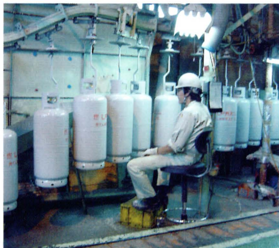
ポンベの目視検査
