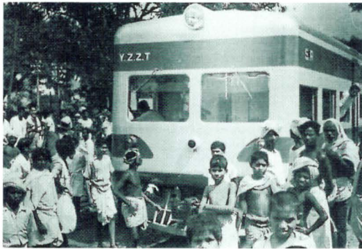
インド国鉄に輸出された車両 DMH17形機関、TC2形トルクコンバータを搭載
