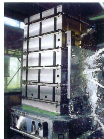
マシニングセンターによるパンチプレートの切削
