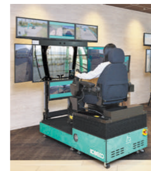
重機の遠隔操作システムと稼働データを用いた現場改善ソリューション「K-DIVE ® 」
