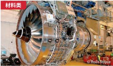
应用于飞机发动机零部件的钛材
