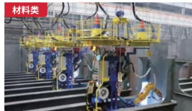
造船大型组装机器人系统
