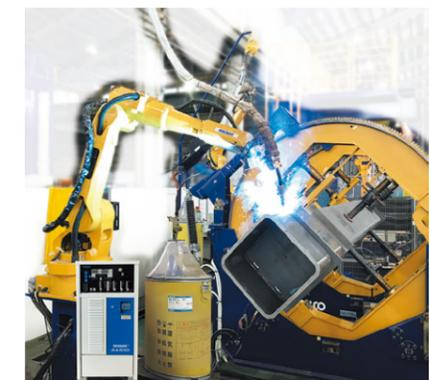
钢结构焊接机器人系统
