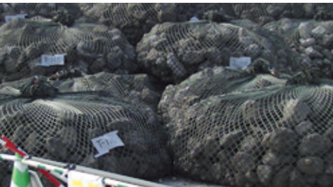
潜堤构建材料 (填料: 钢铁炉渣水和固化体)
