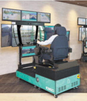
利用重型机械远程操作系统和运行数据实现的现场改善解决方案“K-DIVE®”
