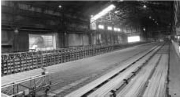
写真2 冷却床および冷却床搬入装置
