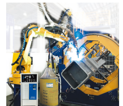
鉄骨溶接ロボットシステム
