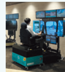
重機の遠隔操作システム「K-DIVE®」
