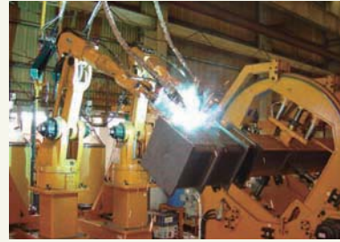
溶接ロボット
