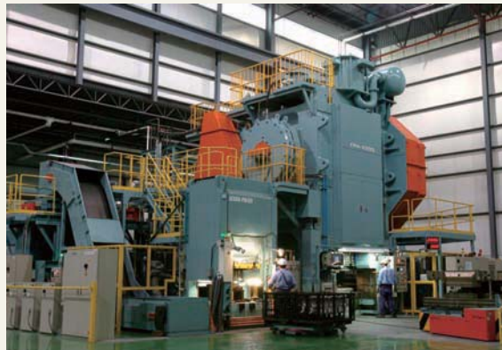
6,300トンメカニカルプレス4機設置し、拡大が予想される需要にグローバルに対応していきます。
