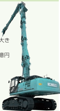
50トン級建物解体専用機 [SK550DLC]
