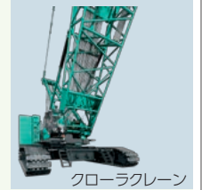
クローラクレーン
