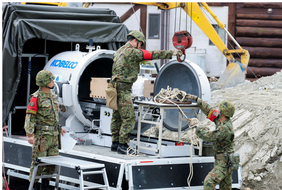
5インチ艦砲弾用耐爆容器を利用した不発弾処理作業の様子
