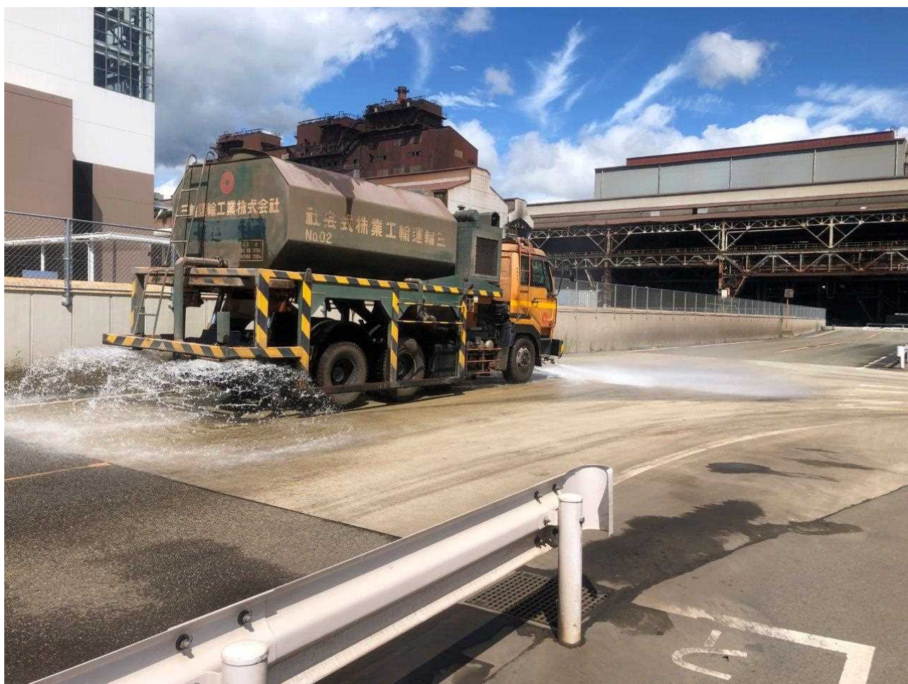
写真 4.1-1 令和4年度における車両洗淨及び道路散水の実施状況
