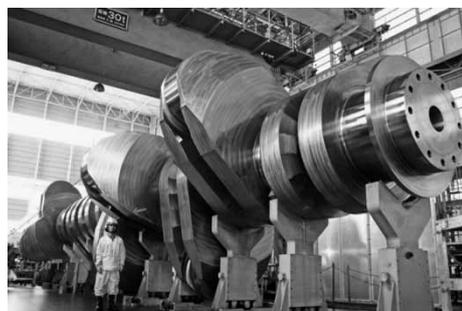
図2 組立型クランク軸
