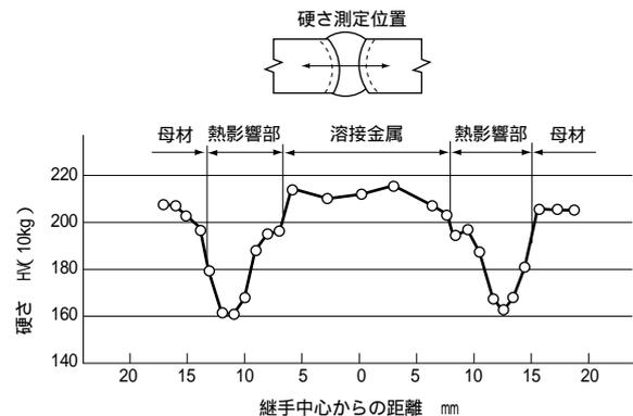
図61 SPV490Q (SPV50Q) 鋼板溶接継手部の硬さ分布<sup>59)</sup>
