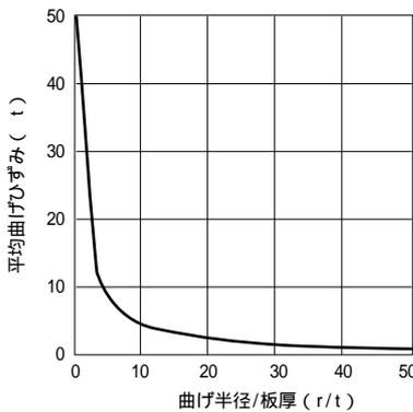
図57 板厚、曲げ半径と曲げひずみの関係<sup>56)</sup>
