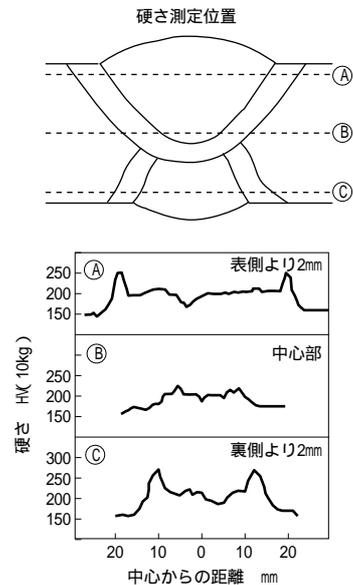
図60 SM490(SM50)鋼板両面溶接継手部の硬さ分布<sup>58)</sup>
