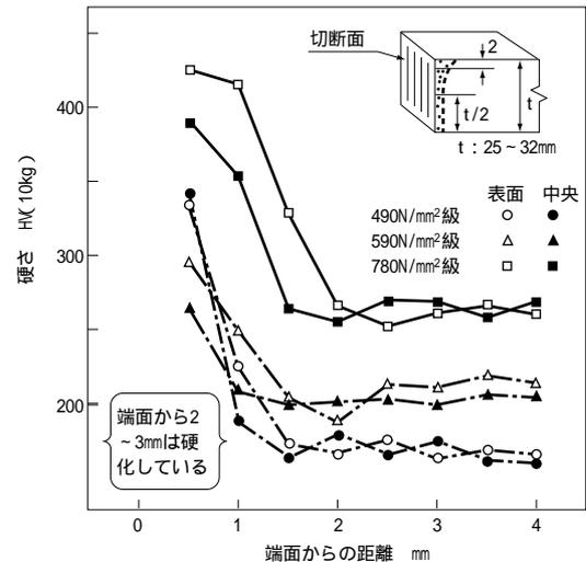
図55 ガス切断面の硬さ分布の例<sup>55)</sup>
