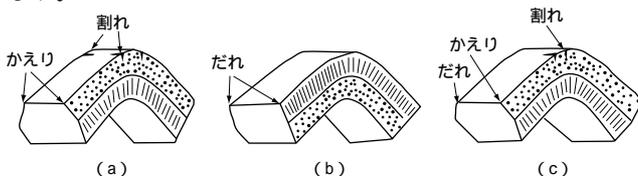
図54 せん断したブランクと割れ発生状況<sup>54)</sup>
