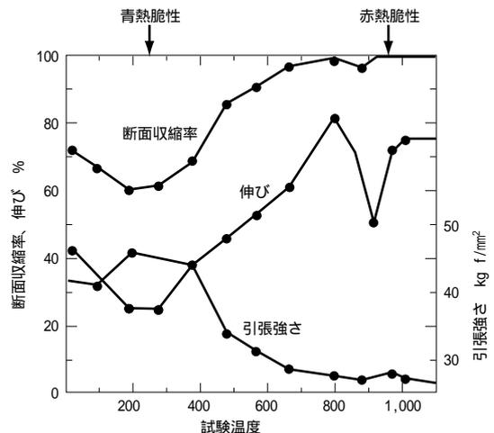
図59 高温における軟鋼の強さ<sup>57)</sup>
