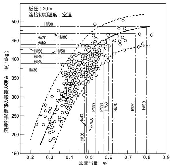
図62 鋼材の炭素量(Ceq)と最高硬さとの関係<sup>59)</sup>
