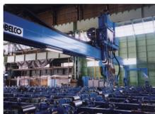
片面板継サブマージ / 溶接装置
