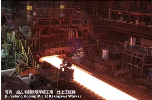
写真 加古川製鉄所厚板工場 仕上圧延機
