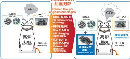
KOBELCOがCO<sub>2</sub>を削減する為に挑戦したのは、HBI\*を高炉に入れて高炉を削減する方法。高炉へ鉄鉱石やコークス等以外の原料を入れるのは難題でしたが、KOBELCOはグループの総合力でCO<sub>2</sub>削減の技術を開発しました。
